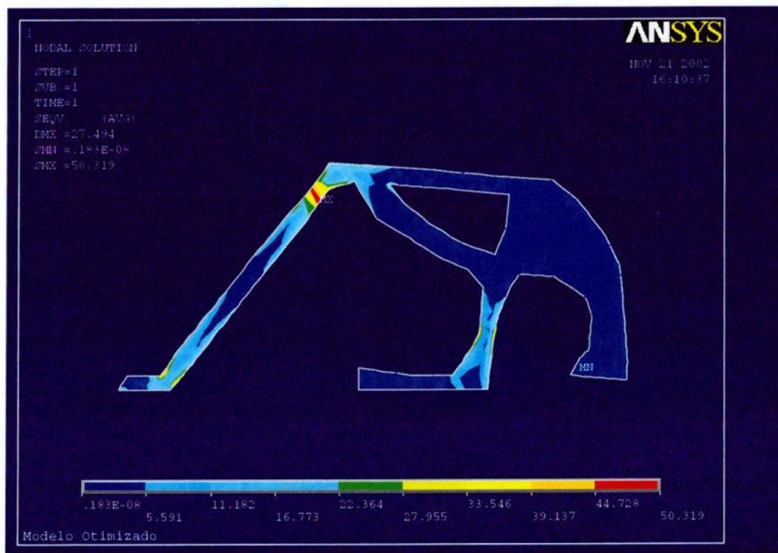
Figura 5.47 – Teste da garra3d – tensão de Von Mises
